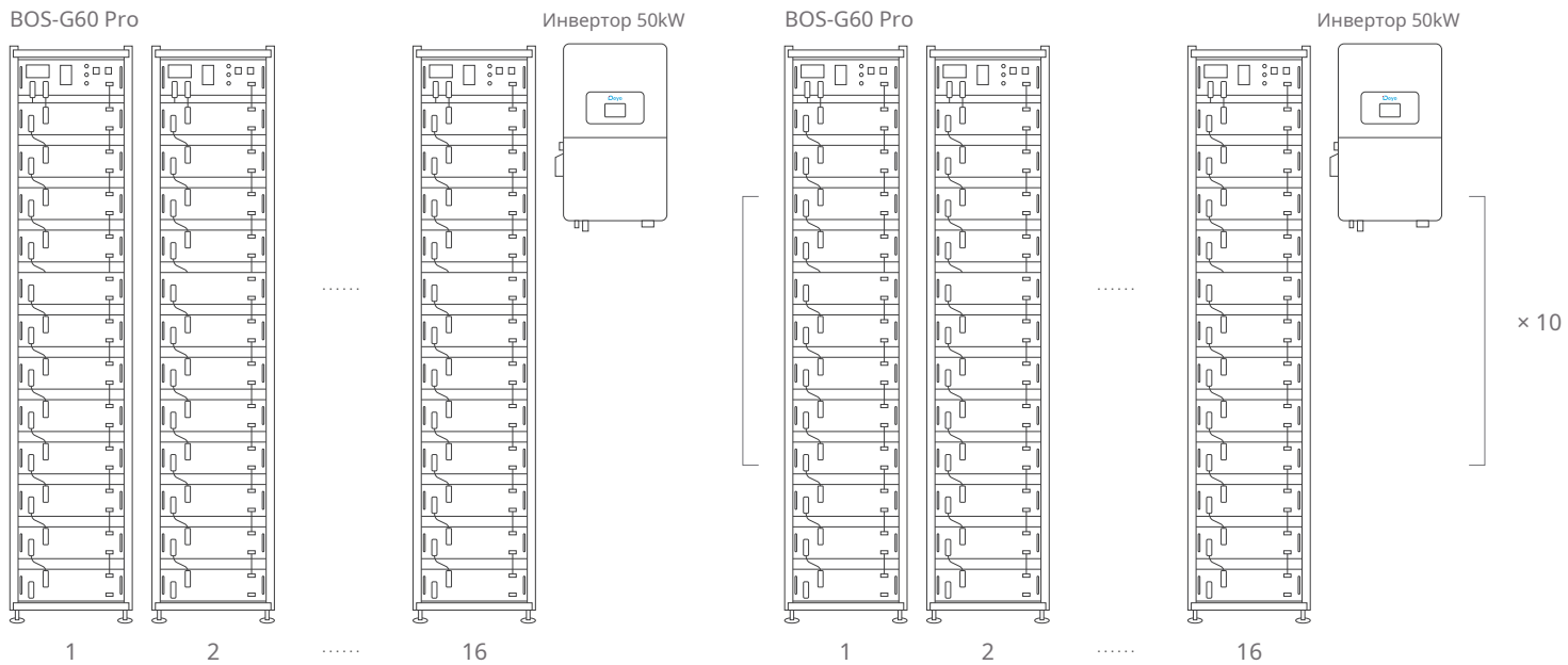
Максимална поддръжка за 16 стелажа с батерии, свързани паралелно
