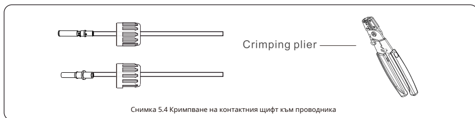
Снимка 5.4 Кримпване на контактния щифт към проводника
