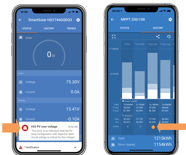
Индикация за грешка #33 на приложението VictronConnect на екрана за състояние и екрана с хронологията.
