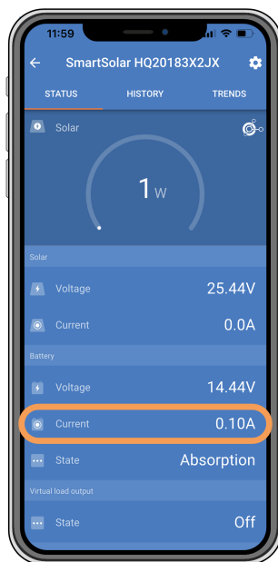
Приложението VictronConnect показва близък до нула заряден ток.
